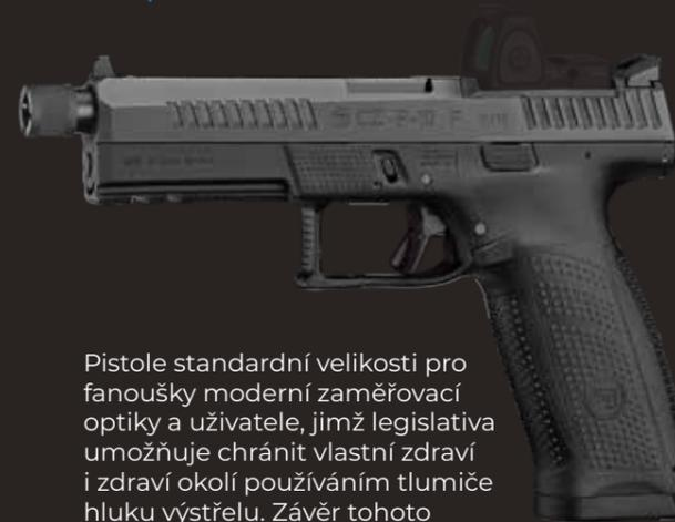
Pistole standardní velikosti pro fanoušky moderní zaměřovací optiky a uživatele, jimž legislativa umožňuje chránit vlastní zdraví i zdraví okolí používáním tlumiče hluku výstřelu. Závěr tohoto provedení je upraven pro snadnou montáž kolimátoru a osazen zvýšenými mechanickými mířidly. Prodloužená hlaveň má na ústí závit 1/2"×28 UNEF - 3A.
